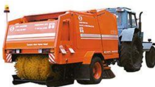
Рис. 8. Трактор МТЗ-82 с подметально-уборочным прицепом
